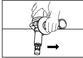
Encienda la herramienta sin que la punta de la rueda haga contacto con la pieza de trabajo y espere hasta que la punta de la rueda alcance la velocidad máxima. Después aplique la punta de la rueda suavemente en la pieza de trabajo. Para obtener un buen acabado, mueva la herramienta lentamente en dirección a la izquierda.
