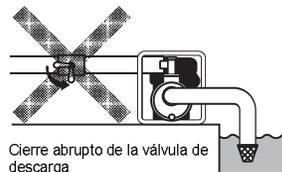
Cierre abrupto de la válvula de descarga
